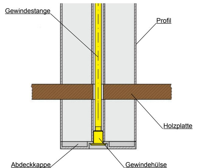
**Befestigung der Holzplatte am Profil mit Hilfe des Gewindestiftes und einer in das Holz eingelassenen Gewindehülse (Rampamuffe).**
