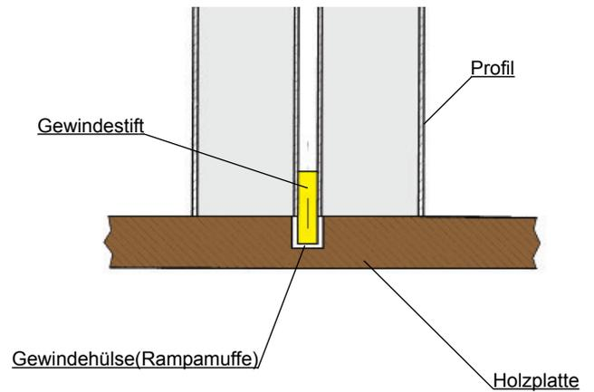
**Verbindung von zwei Profilen durch die Glas- oder Holzplatte hindurch mit Hilfe eines Gewindestiftes**
